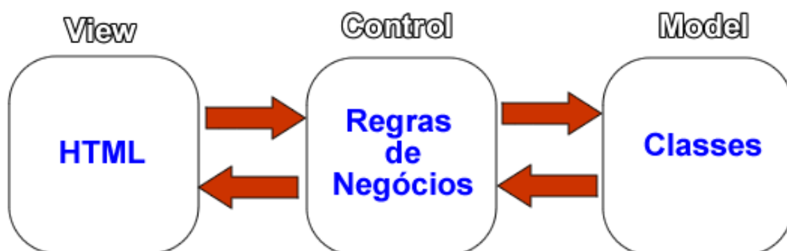
Figura 4.1.a: Fluxo do funcionamento do modelo MVC.
